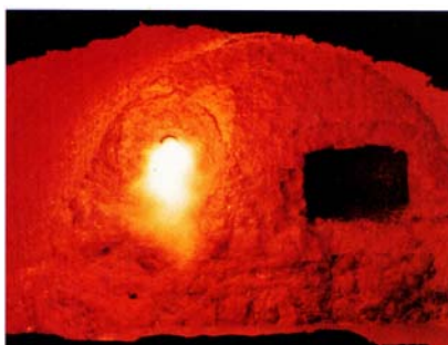
Horák s nízkym obsahom NO x : typ Oxipyr®-LON v nistejovej peci na tavenie hliníka
