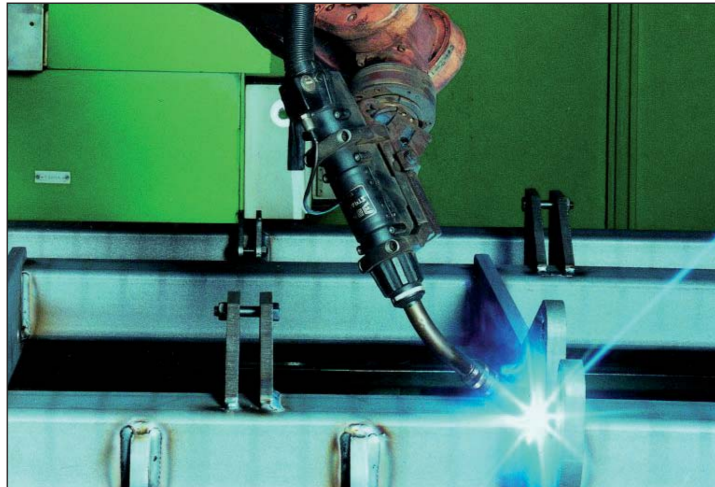
Robotizované MAG zvaranie
