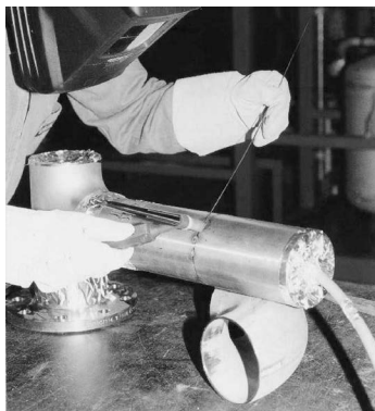
Obrázok 6 Zváranie CrNi ocele metódou TIG so súčasťou ochranou koreňa zvaru
