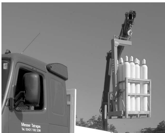
Obrázok 20 Paleta typ 1250 s 12 tlakovými fľašami
