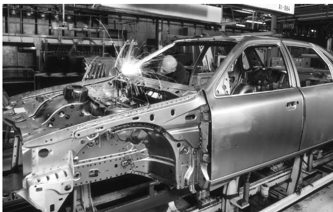
Obrázok 1 MAG zváranie automobilovej karosérie
